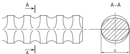
Проволока из низкоуглеродистой стали холодноотянутая – периодического профиля класса Вр-1 для армирования железобетонных конструкций изготавливается из катанки по ОСТ 14-15-193.
